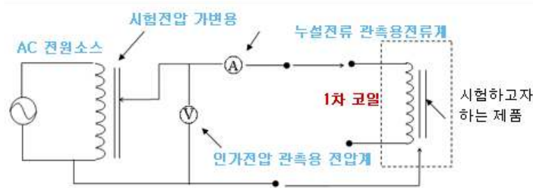
[그림 3-2] 내전압 시험 회로도 예시
