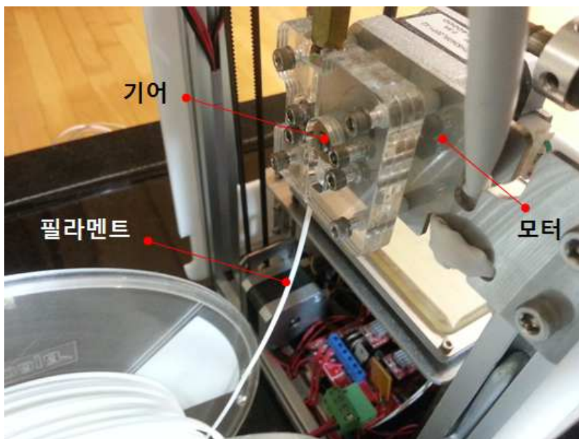
[그림 1-4] 재료 압출형 3D프린터 필라멘트 공급 장치 구성도
