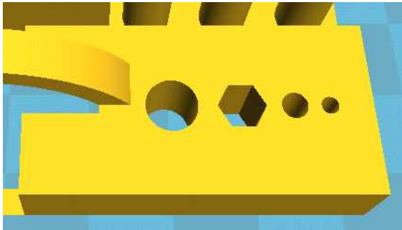
[그림 1-10] Torture test 모델의 다양한 구멍 형상
